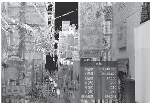
図 - 2 道路境界から越境している看板座標 (かなり上方まで観測していました。)
